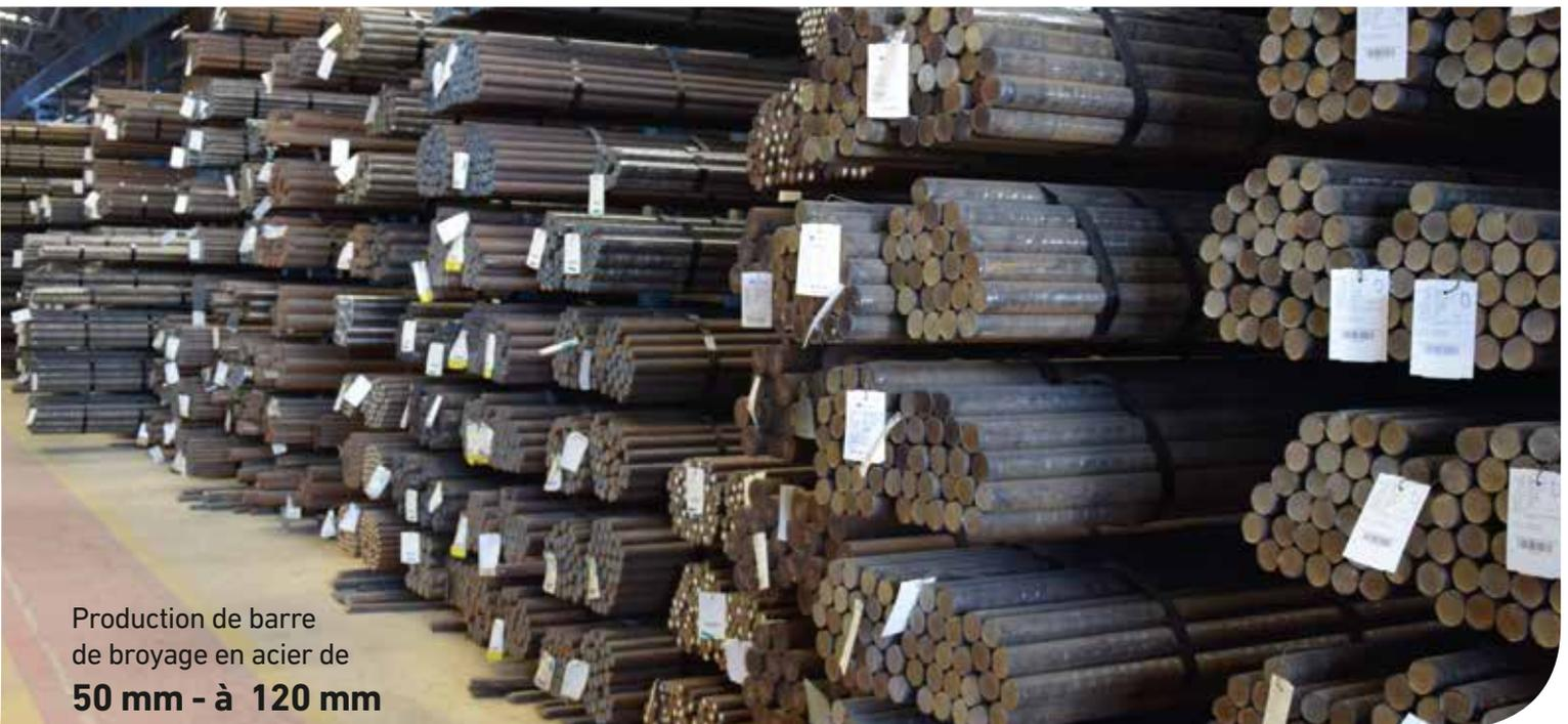
Production de barre de broyage en acier de **50 mm - à 120 mm**
